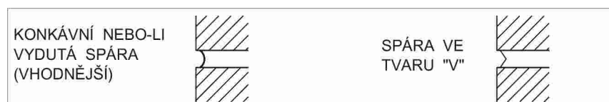
Obr. 1 – Tvary spár pro exteriérové zdivo: vydutá spára a spára ve tvaru „V“
